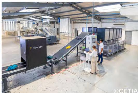
Développée il y a 4 ans dans le cadre d'un programme européen, Fibersort est une machine de tri textile qui utilise l'IA pour identifier et séparer les textiles en fonction de la composition des fibres et des propriétés de la couleur. La machine prédit la concentration des fibres sur la base de scans de spectroscopie proche infrarouge (NIR) et trie les textiles par couleur à l'aide d'une caméra RVB.
